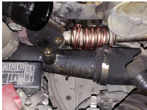
tubo metálico precalentador de hidrogeno instalado en el colector de escape de un vehículo
